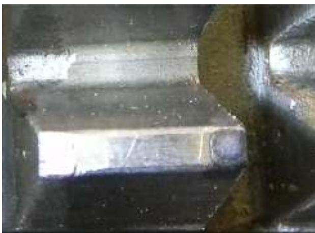
Рис. 1. Фотография зуба фрезы инструментальной стали P18K5Ф2, обработанного в режиме закалки без оплавления
